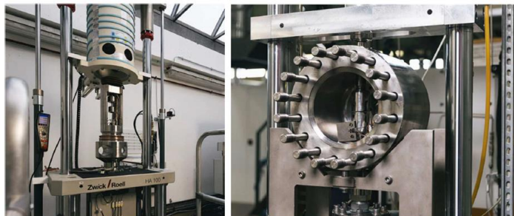
Figura 3.- Autoclaves para realizar ensayos bajo presión de hidrógeno. Extraído de [4]
