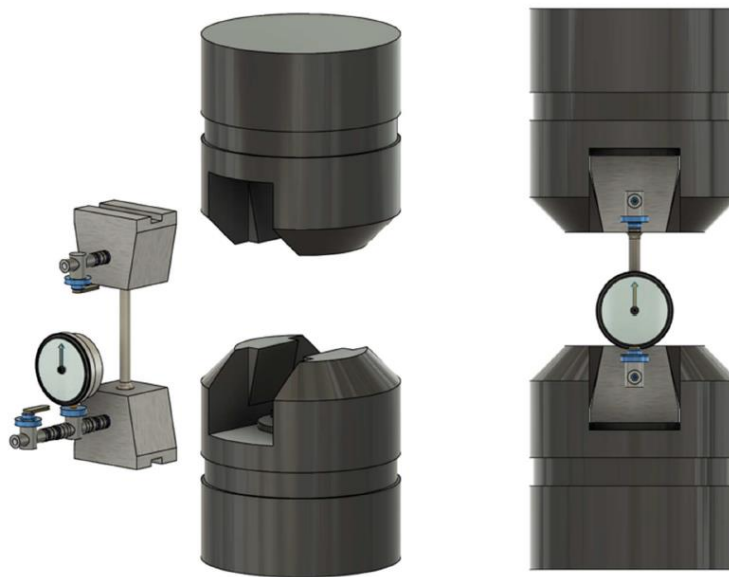
Figura 6.- Conjunto de adaptadores y mordazas de máquina de tracción universal.
