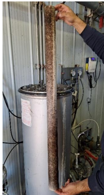
Figura 14. Confirmación de saturación prematura de cartuchos. Fuente: Confidencial.
