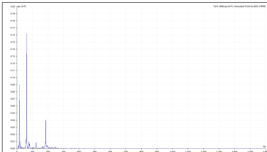
Figura 2: Espectro de vibración de la canasta a 950 RPM, en sentido horizontal.
